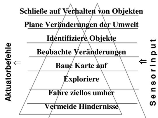
Abb. 7: Verhaltensbasierte Dekomposition
